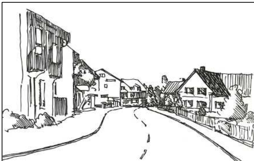
Abb. 34 Ansicht einer Verschwenkung
